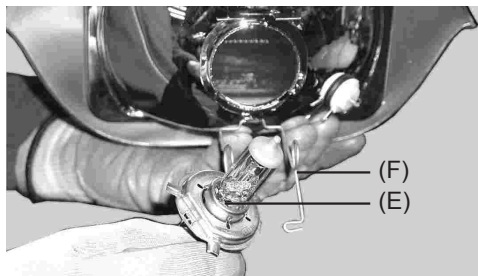
(F). Alambres de sujeción de la bombilla.
