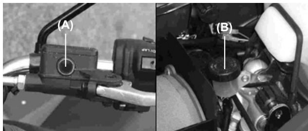
(A) Y (B). Depósitos de líquido de frenos delantero y trasero.
