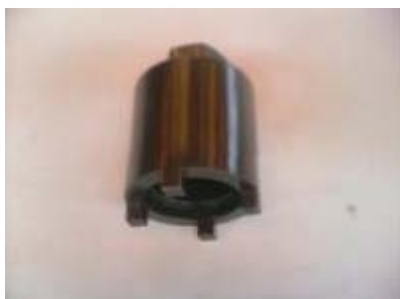
TEILENR: TGB-440663 TEIL: Getriebewellenschlüssel
