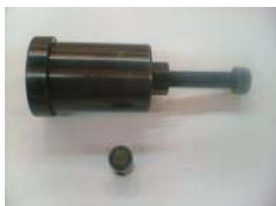
TEILENR: TGB-440659 TEIL: Magnetscheibenabzieher
