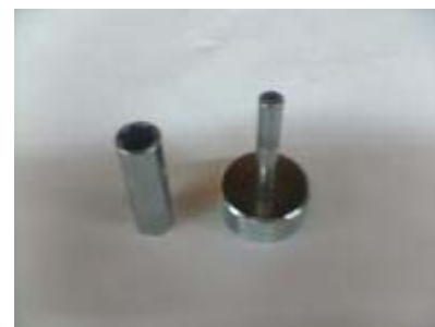
TEILENR: TGB-440662 TEIL: Ventileinstellwerkzeug
