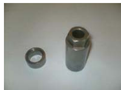
TEILENR: TGB-440660 TEIL: Kettenrad-(TGB-924360) und - scheiben (TGB-924718) Montagewerkzeug
